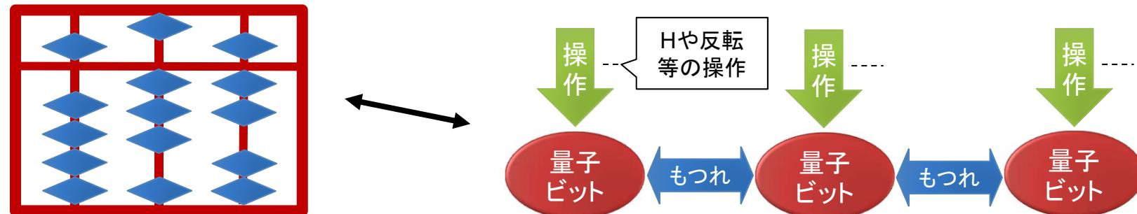
量子ゲート型は量子ビットを配置したハードウェアを、レーザーや電界で弾いて行くことで計算を進めて行く。各量子ビット間には量子もつれによる関連性がある。
