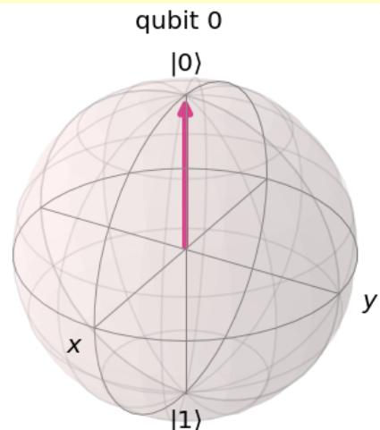
各量子ビットの初期状態は  $|0\rangle$  なので、左のように  $|0\rangle$  のブロッホ球が表示されるはず。
